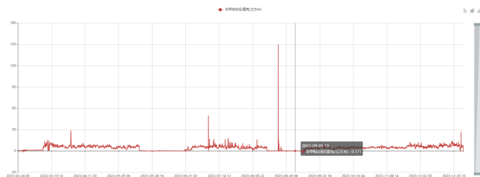
FQ-30331 有机废气排气筒 NMHC 在线监测结果
